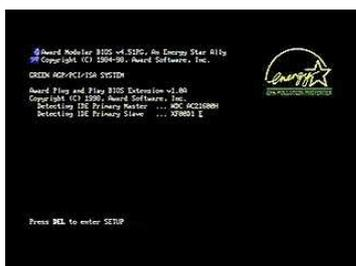
Una schermata iniziale, con una serie di numeri che cambiano rapidamente e altri messaggi in inglese. Si tratta dell'avvio del **BIOS** - la parte più elementare del sistema operativo, che sonderà la presenza di dischi, mouse, schede varie.
