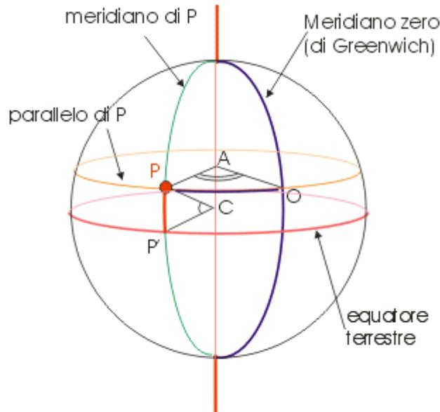
**Piano equatoriale:** piano perpendicolare all'asse e passante per il centro della Terra
