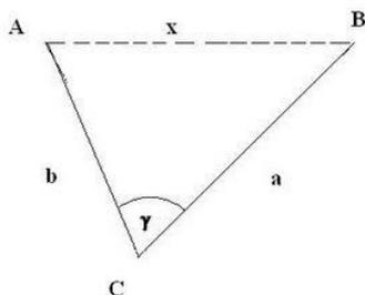
Fissiamo un punto C (accessibile) di cui è possibile misurare la distanza b da A ed a da B. Da C inquadriamo A e B (per esempio con un teodolite) e misuriamo l'angolo  $\widehat{ACB} = \gamma$ . Per trovare x possiamo perciò applicare il teorema del coseno (detto di Carnot):
