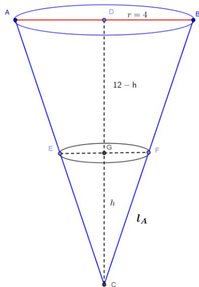
Dobbiamo calcolare il volume  $V$  del cono di altezza  $CG = h$  in funzione dell'apotema  $CF = l_A$ . Risulta:
