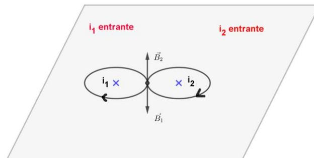
Il campo totale (nei punti del piano equidistanti dai due fili) è perpendicolare al piano del foglio ed ha il verso di  $\vec{B}_2$  (poiché l'intensità di  $\vec{B}_2$  è maggiore dell'intensità di  $\vec{B}_1$ ) ed ha intensità, per la legge di Biot-Savart, pari a:
