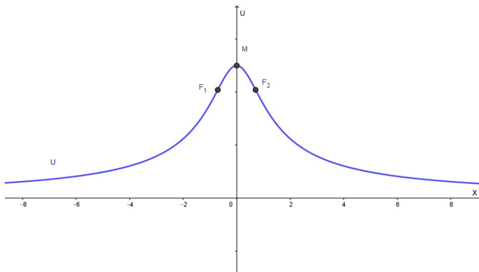
Il coefficiente angolare della tangente in  $F_2$  è  $U' \left( \frac{\sqrt{2}}{2} \right) = \dots = -\frac{8}{9} kq^2 \sqrt{3}$ ; il coefficiente angolare della tangente in  $F_1$  è  $U' \left( -\frac{\sqrt{2}}{2} \right) = \dots = \frac{8}{9} kq^2 \sqrt{3}$ ;
