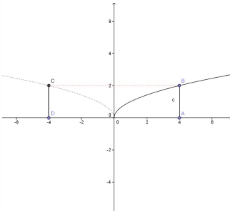
L'integrale  $\int_0^4 2\pi x(\sqrt{x})dx$  fornisce il volume del solido generato da R nella rotazione attorno all'asse y. Infatti:
