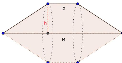
Il suo volume è dato dalla somma dei volumi dei due coni con raggio di base h e altezza (B-b)/2 e del cilindro con raggio di base h e altezza b:
