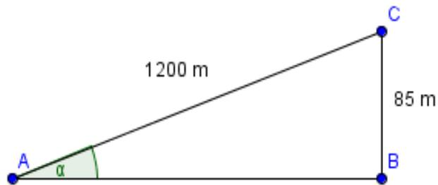
Dai dati forniti si ricava l'inclinazione **alfa** della salita:
