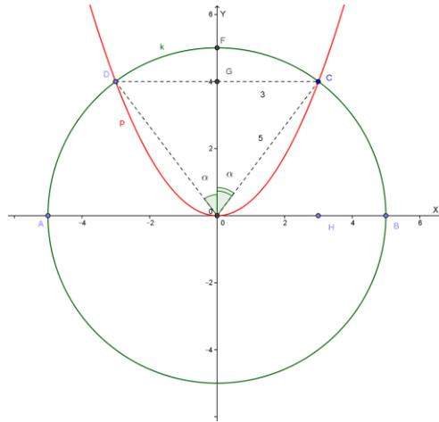
La regione DOCF si ottiene sommando al segmento parabolico DOC il segmento circolare DCF; quest'ultimo si ottiene sottraendo al settore circolare DOCF il triangolo DCO.
